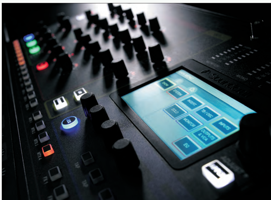
Dotykový displej nabízí rychlý přístup k základním konfiguračním funkcím mixu. Kulaté tlačítko LEX pak přepne displej do režimu, zobrazujícího parametry nastavení jednotlivých FX procesorů.
