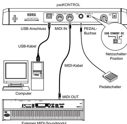
**Ann.** Das padKONTROL kann als USB-MIDI-Schnittstelle eingesetzt werden. Sie können an den MIDI OUT-Anschluss ein MIDI-Soundmodul oder ein anderes Gerät anschließen und das MIDI-Soundmodul von Ihrem Computer aus steuern.
